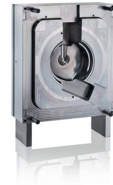
**Bild 2.** Auf diesem mehrteiligen Formwerkzeug werden Pumpentöpfe aus XYZ-xyz für die nahrungsmittelverarbeitende Industriespritz. © Hermle
