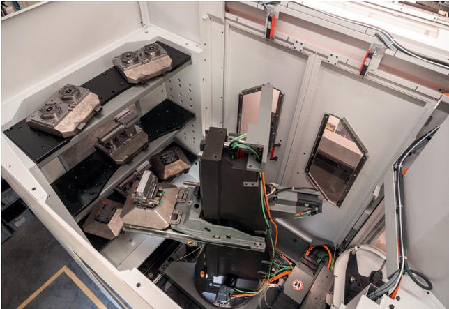
**Bild 3.** Da Wiegelmann auch kleinere Artikel fräst, die teilweise nur zehn oder zwanzig Minuten laufen, hat sich der Formenbauer dieses Mal für ein automatisiertes Bearbeitungszentrum entschieden: die C 42 U mit HS flex. © Hermle
